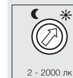
Регулятор, установленный на ☼ = режим дневного освещения ок. 2000 лк.
